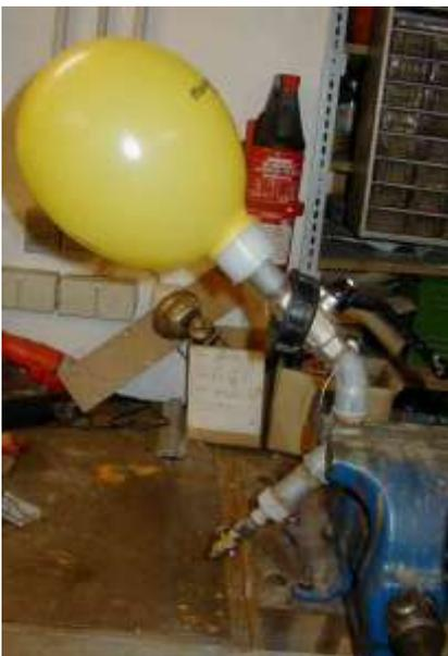
April 2004: Dichtheitsprüfung Benzinahn => Luftballon drückt Benzin gegen die Dichtung
